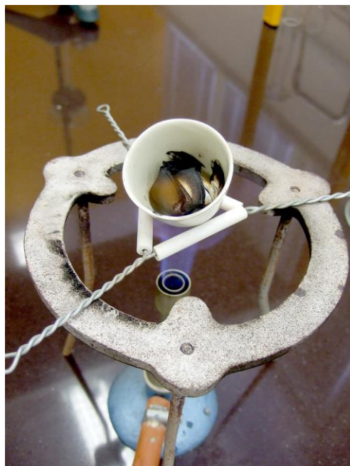
Obrázek 7: Žihání sraženiny \text{Fe}(\text{OH})_3
