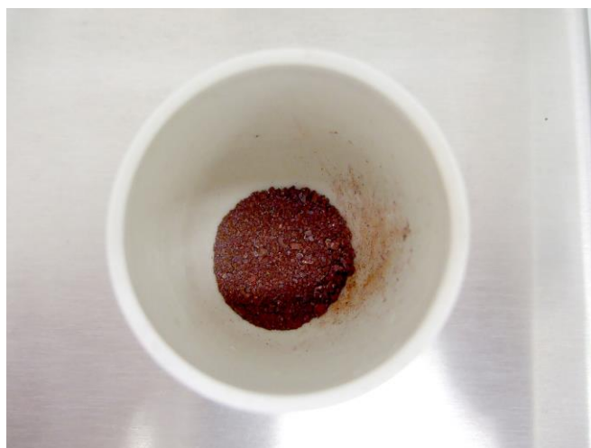
Obrázek 9: Vzniklý oxid železitý
