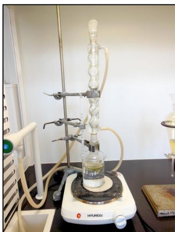
Obrázek 7: Aparatura se zpětným chladičem
