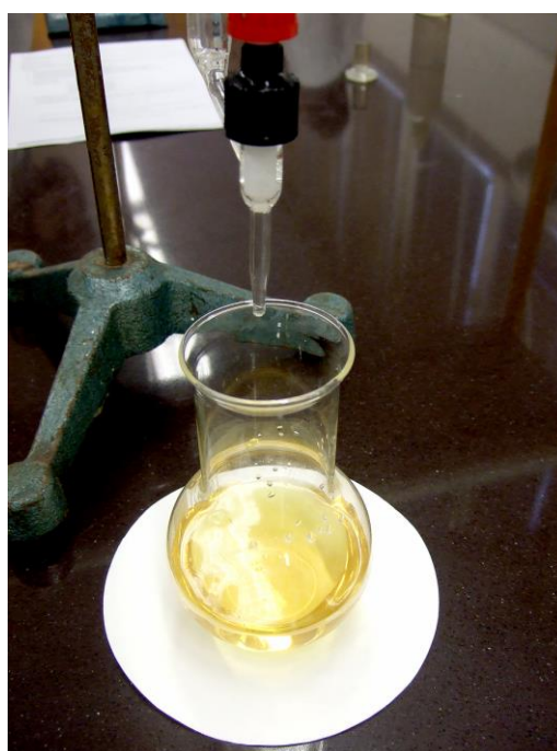
Obrázek 7: Světle žluté zbarvení roztoku vzorku před přidáním škrobového mazu
