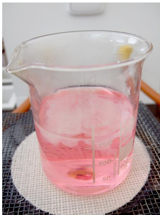
Obrázek 3: Vznik bílé sraženiny hydroxidu hlinitého při opatrném přidávání roztoku amoniaku
