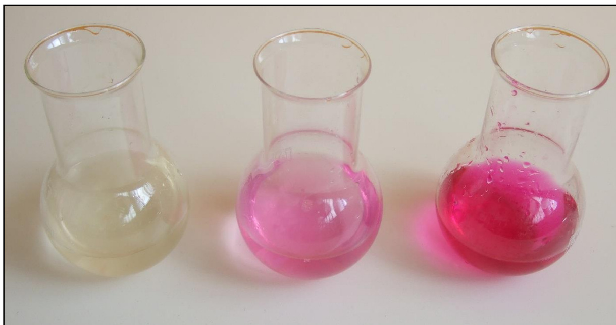
Obrázek 3: Roztok kyseliny jablečné a) před titrací (vlevo) b) v bodě ekvivalence - na konci titrace (uprostřed) c) roztok přetitrovaný (vpravo)
