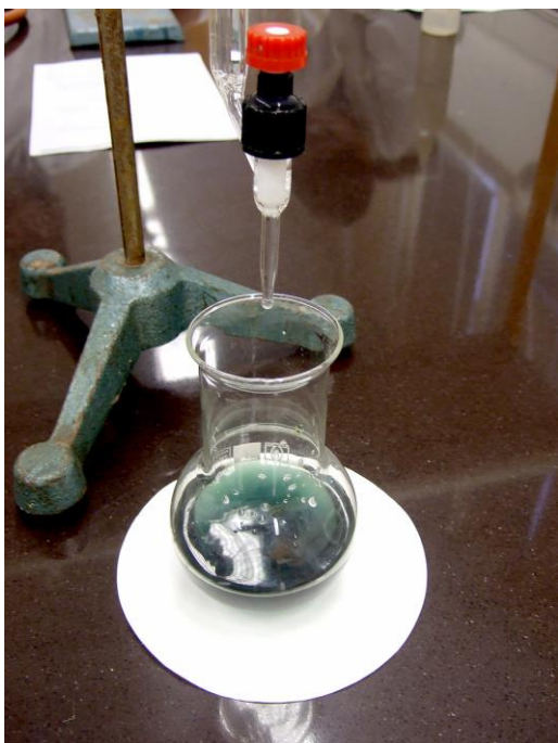
Obrázek 8: Roztok vzorku po přidání škrobového mazu
