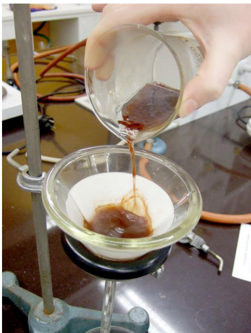
Obrázek 6: Filtrace vzniklé sraženiny \text{Fe}(\text{OH})_3
