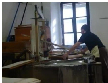
Obrázky 11 a 12: Nabírání papíroviny na síto
