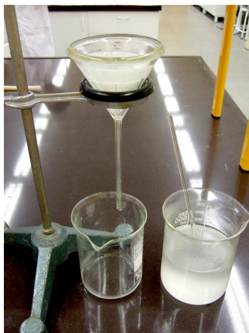
Obrázek 1: Filtrace škrobového mazu
