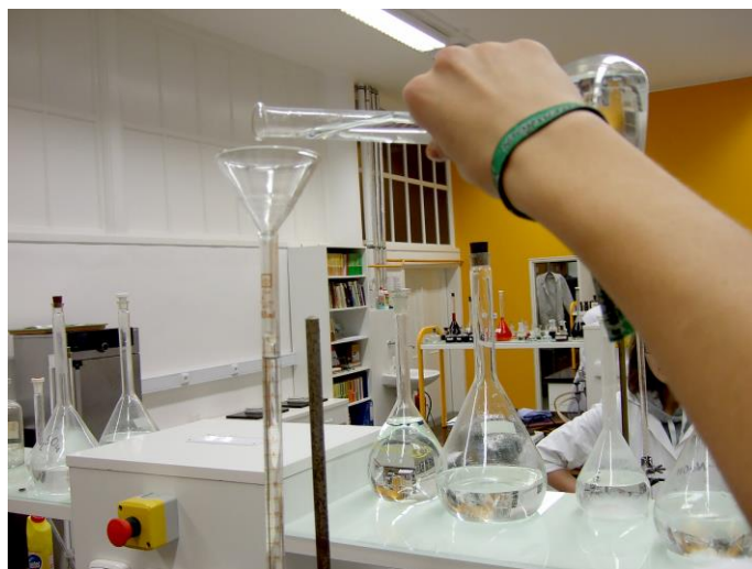
Obrázek 4: Plnění byrety odměrným roztokem
