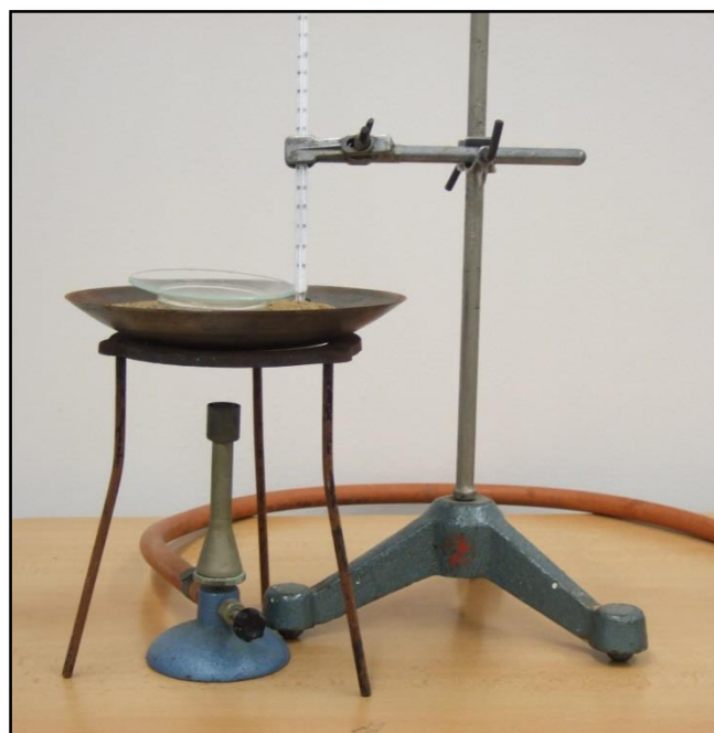
Obrázek 7: Kompletní sublimační aparatura
