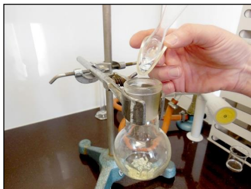
Obrázek 5: Přidávání granulovaného zinku
