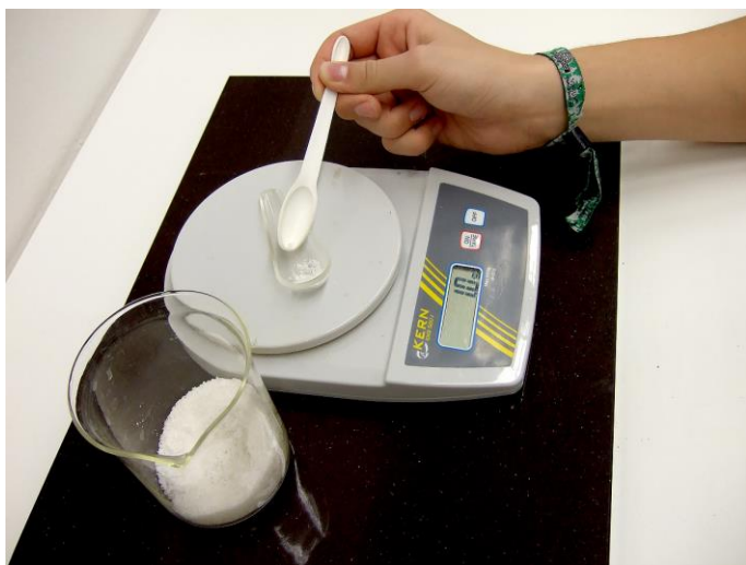
Obrázek 3: Navažování pentahydrátu thiosíranu sodného pro přípravu odměrného roztoku
