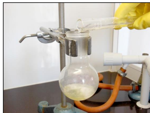
Obrázek 6: Přidávání koncentrované kyseliny chlorovodíkové
